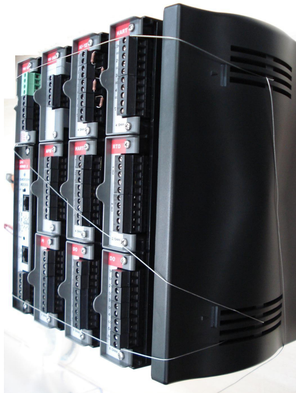
Detalhe da Selagem - Lateral
