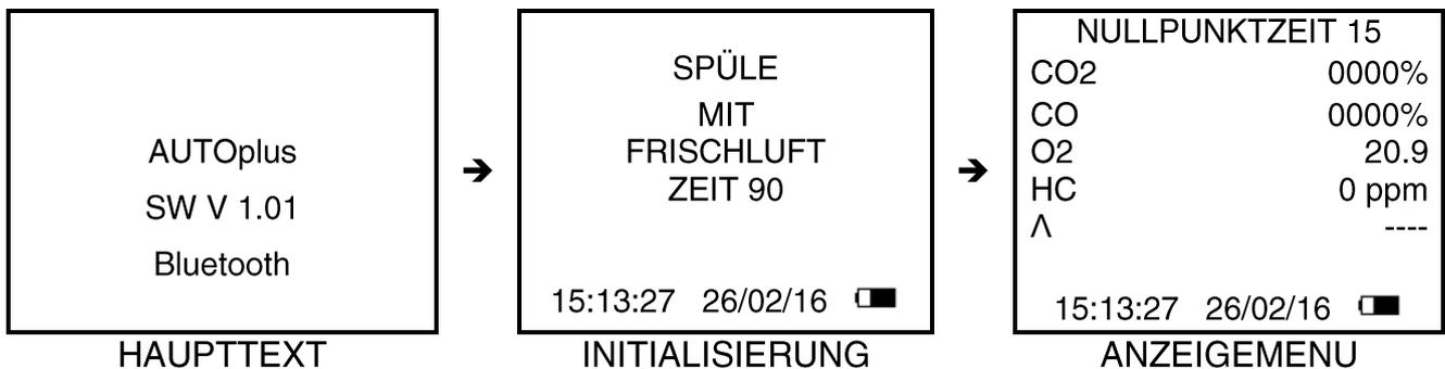
**ACHTUNG:** Falls die O2 Messwerte nach einem automatischen Nullpunkt ausser Bereich sind, bitte Abschnitt 8.1 nachschlagen und ein manueller Nullpunkt durchführen.
