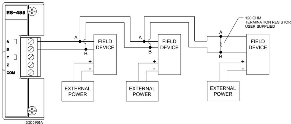
*Figure 2. Module Wiring*
