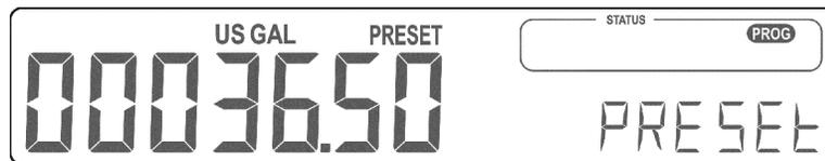
Figura 19: Ejemplo de visualización de información durante la programación de preajuste de valor
