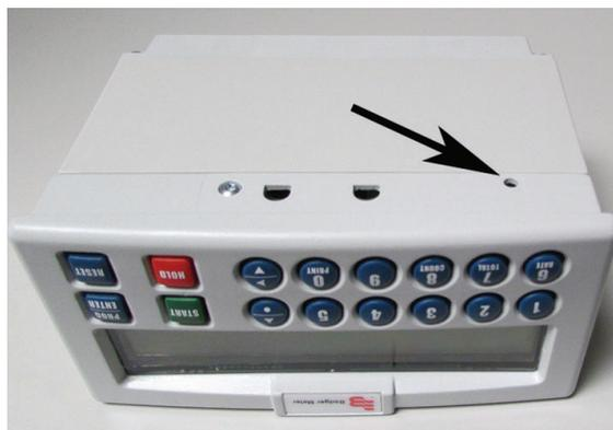
Figura 4: Conexión a tierra de la ubicación, la vista de la parte inferior
