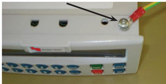
Figura 3: Conexión a tierra ubicación, vista superior
