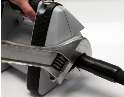
Figura 12: Conexión hexagonal del motor
