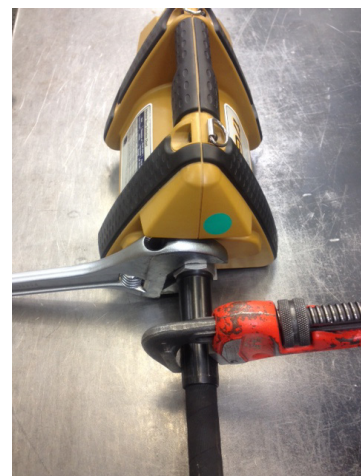
Figura 11: Colocación de la llave ajustable y la llave de tubo
