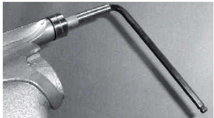
Figura 16: Extracción del cojinete
