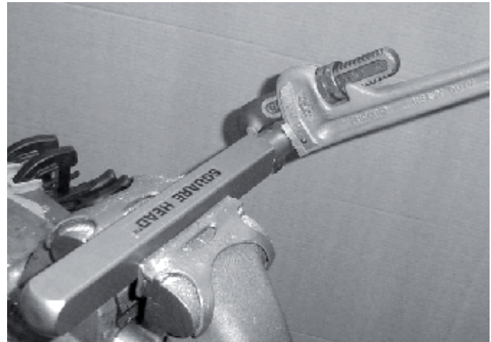
Figura 15: Extracción de la tapa
