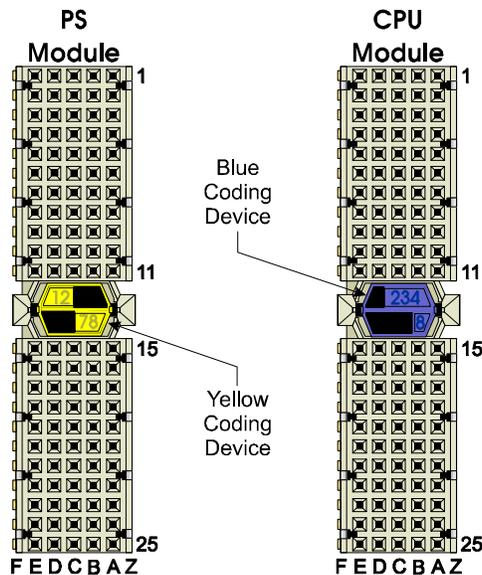
**Figure 4-1 - Power Supply Bd. & CPU Bd. Backplane Connectors**
